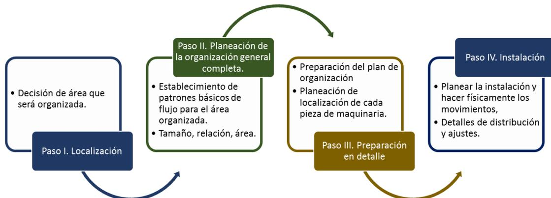
Figura 2. Los cuatro pasos de la planeación sistemática de la distribución en planta. (Muther, 1981)
