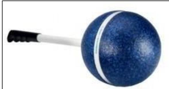
Figura 8. Antena isotrópica.
