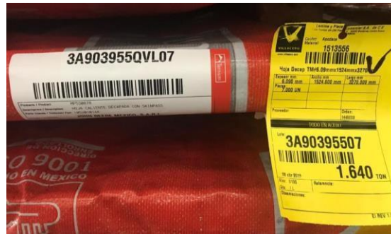
Figura 5. Se muestra el paquete 07 del lote origen 3A903955 con las dos etiquetas, Villacero y Ternium, esta es la manera en la que deben salir todos los paquetes.
