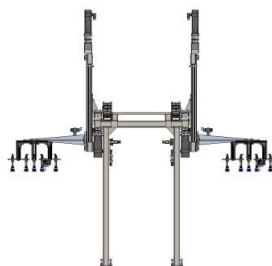
Figura 1.- Diseño y montaje de Gantry con herramienta de vacío.
