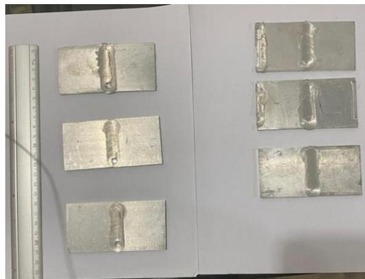
**Fig. 2. Soldadura por fricción-agitación**
