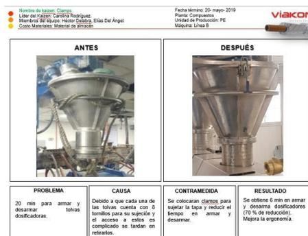
Ilustración 3: Kaizen clamps de sujeción.
