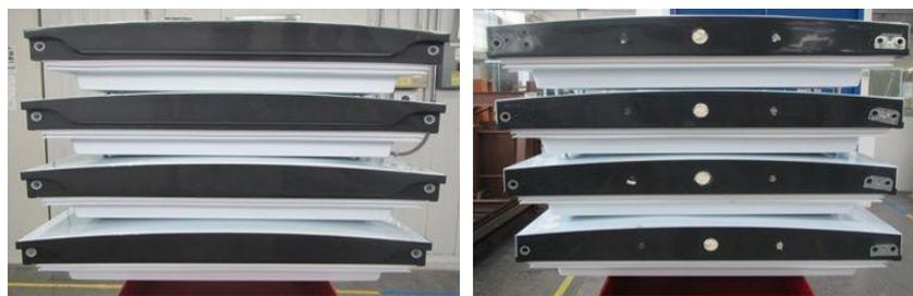
Figura 4. Endcaps superior e inferior de puertas PC después de proceso de ciclado térmico. Resina LOTTE
