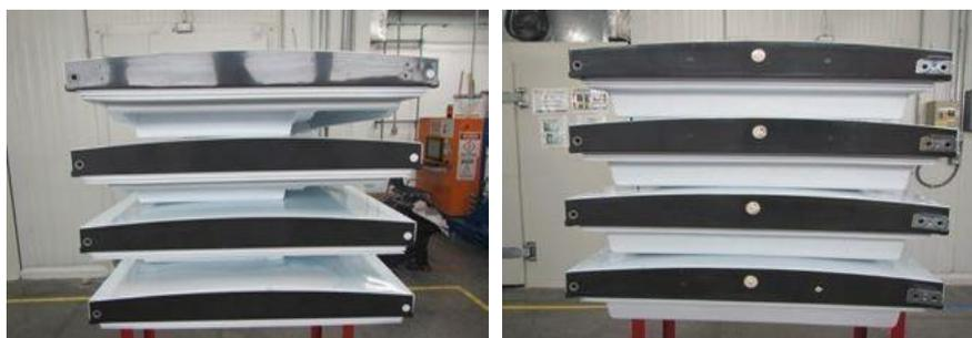
Figura 5. Endcaps superior e inferior de puertas PI después de proceso de ciclado térmico. Resina LOTTE
