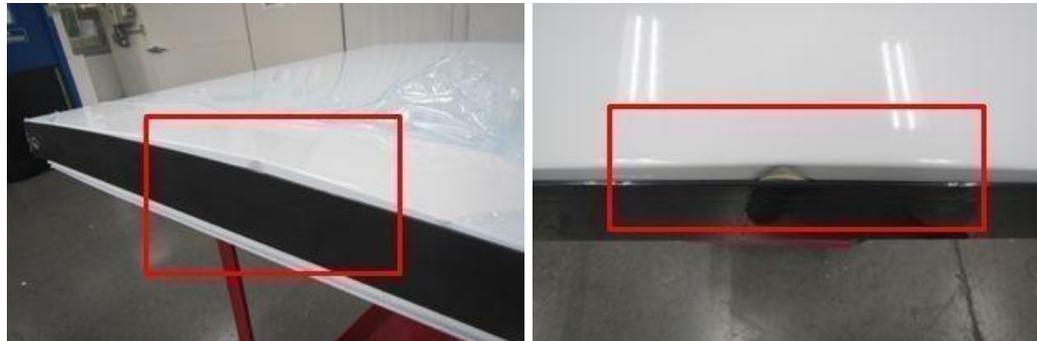
Figura 6. Deformaciones en acero de las puertas después de ciclado térmico. Resina LOTTE
