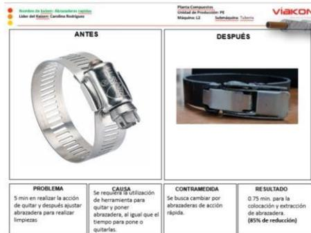
Ilustración 2: Kaizen abrazaderas de acción rápida.
