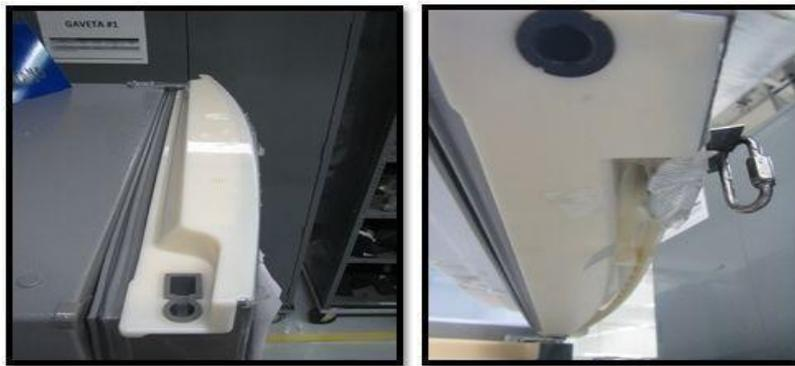
Figura 10. Endcaps (superior e inferior) de puerta PC, sin daños después de prueba Door Operation.
