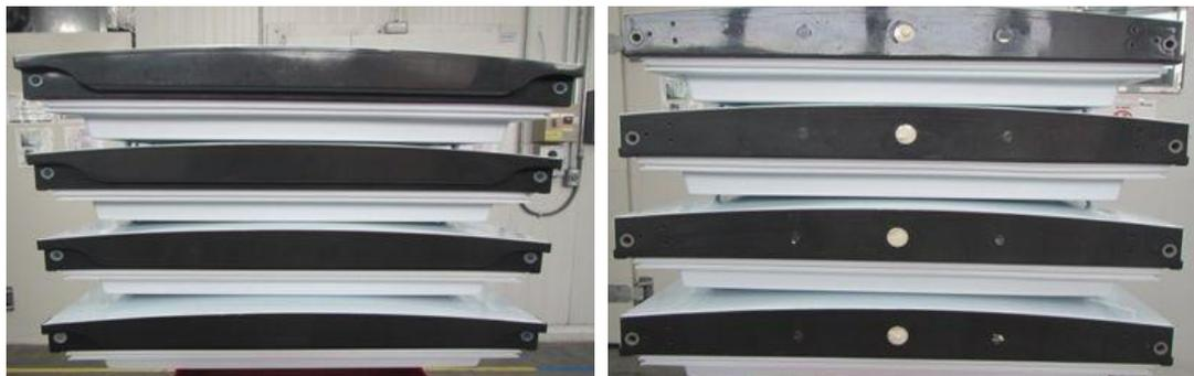
Figura 7. Encaps superior e inferior de puertas PC después de proceso de ciclado térmico usando resina SABIC
