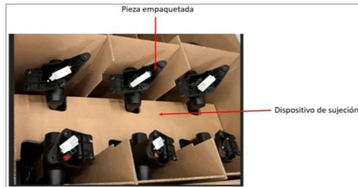
Figura 5. Dispositivo de sujeción para eliminar el movimiento causado por la inercia durante la transportación.
