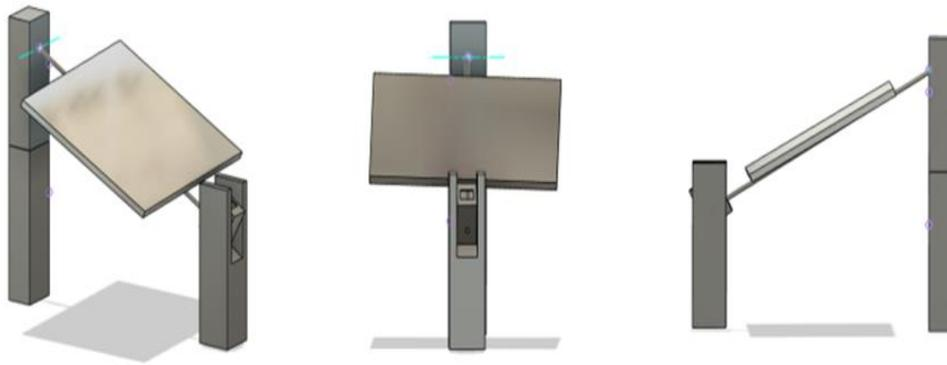
Figura 4. Estructura móvil encargada de sujetar y mover el panel de este a oeste
