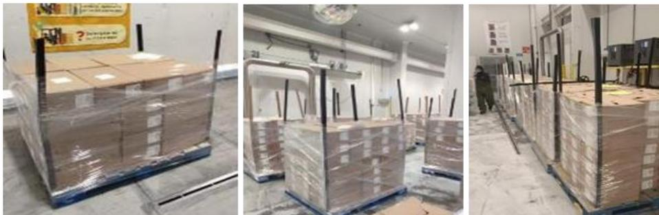
**Figura 14. Muestran el producto en tarima listo para embarcarse, con playo colocado por el personal operativo y los esquineros reutilizados para brindar mayor soporte**
