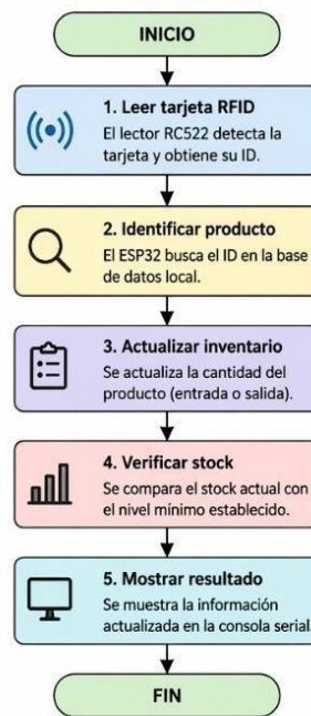
Figura 5. Flujo general del funcionamiento del sistema.
