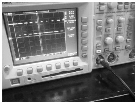
**Figura 18.** Salida del inversor ya mostrada en un osciloscopio
