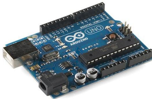
**Figura 3.** Placa de desarrollo Arduino Uno, con microcontrolador ATmega328.
