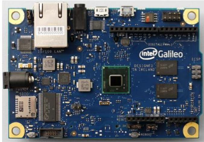
**Figure 1.- Intel Galileo Board.**
