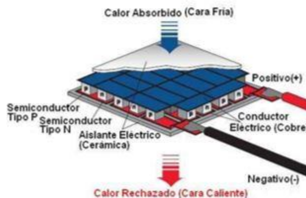
Figura 1. Diagrama que muestra la estructura interna de una celda Peltier, donde se muestran los elementos semiconductores dispuesto eléctricamente en serie y térmicamente en paralelo.
