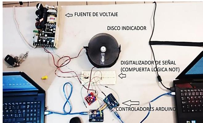
**Figura 6.** Partes del sistema inteligente, con las dos tarjetas arduino.
