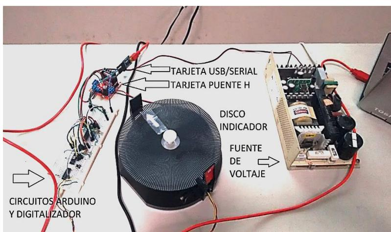
**Figura 8.** Prototipo del sistema inteligente en proto-board.
