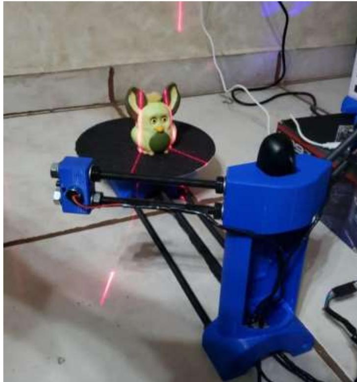
Figura 7. Mesa calibrada iniciando proceso de digitalización.
