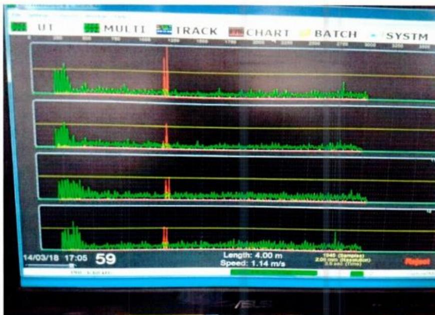
Anexo 3. Detección de defectos en Eddy Current 02. Método más eficaz para detectar discontinuidades en soldaduras.
