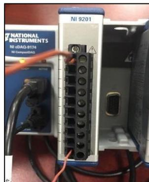
Figura 3. Conexión al módulo NI 9201 con el canal AI0 y el COM a la tierra del circuito.
