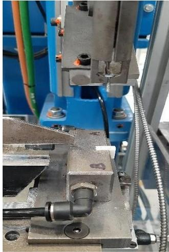
Figura 2. Fixture y atornilladora automática
