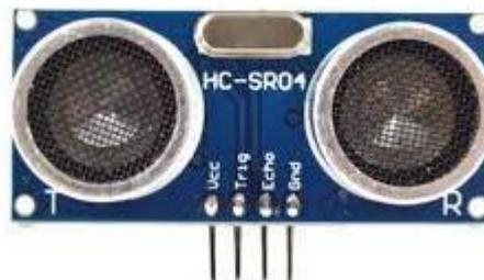
**Ilustración 2.2.4.4 Sensor Ultrasónico HC-SR04**
