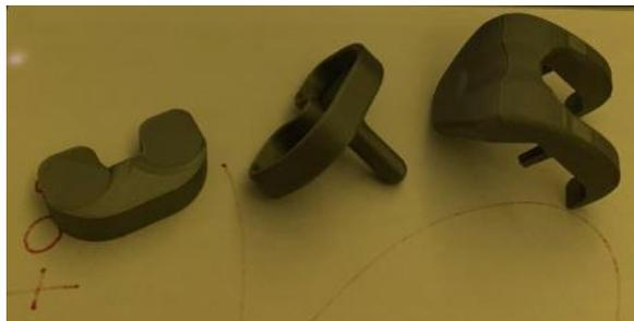
Figura 23. Piezas de componentes tibial, inserto y femoral impresos en 3D.
