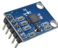
Ilustración 2.2.3.1 Acelerómetro ADXL33
