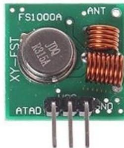
Ilustración 2.2.1.1 Transmisor RF de 433MHz
