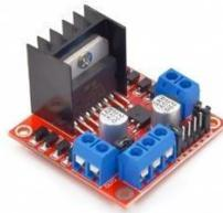
**Ilustración 2.2.4.2 Diagrama del controlador de motores o Puente H**
