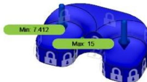
Figura 13. Análisis de factor de seguridad del inserto tibial diseñado y simulado en fusion 360
