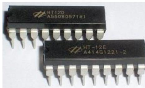
Ilustración 2.2.2.1 Circuitos HT12D Y HT12E
