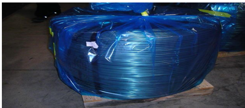
Figura 2 Prueba con bolsa de VCI
