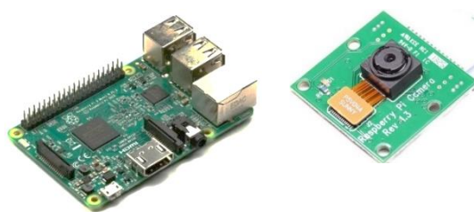
Figura 10. Computadora embebida Raspberry pi modelo 3b y Cámara Raspicam de 5 mega pixeles
