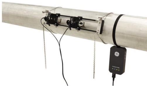
Figura 2.4 Colocación del medidor de flujo ultrasónico.
