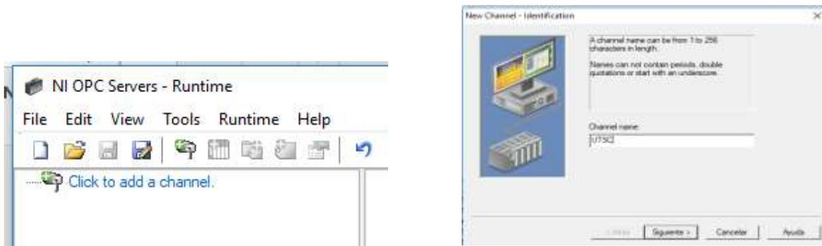
Figura 9. Crear canal de comunicación OPC Server con PLC
