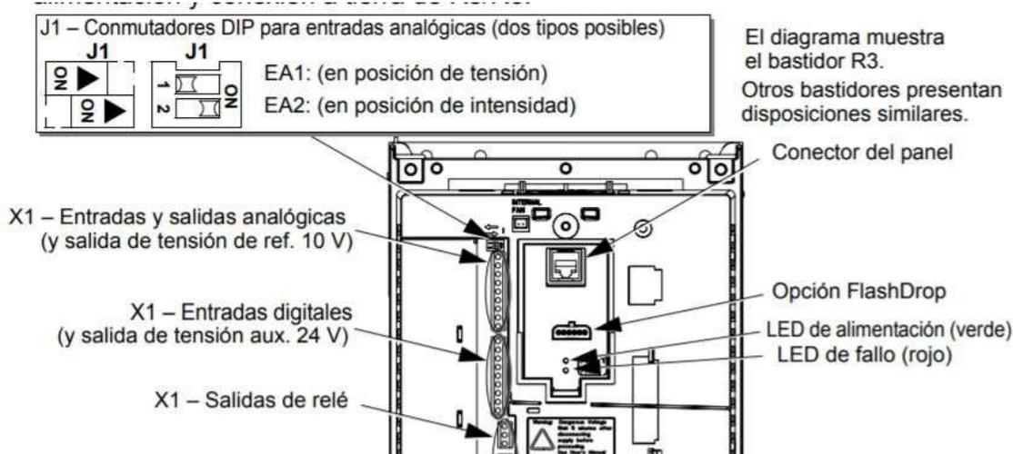
Figura 20 Panel de conexiones del variador de frecuencia ACS-550
