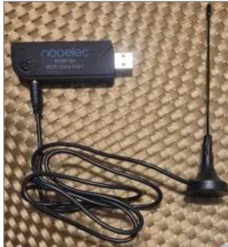
Figura 1. Adaptador RTL-SDR marca nooelec.
