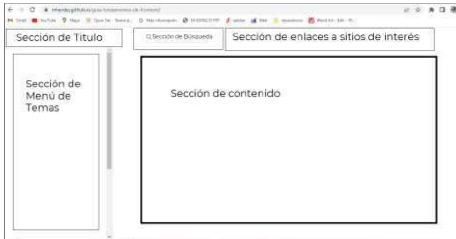
Figura 2. Diseño de estructura de la página.
