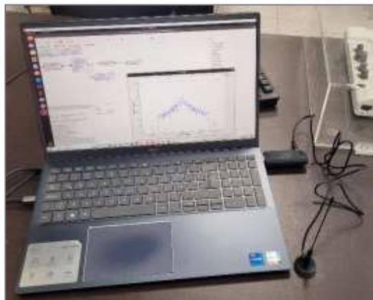
**Figura 4. Configuración de equipo con programa de GNURADIO y RTL-SDR.**
