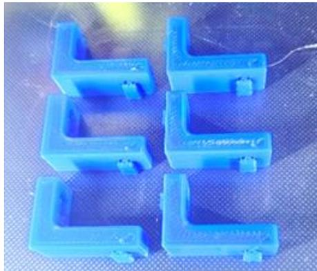
Figura 4. Piezas angulares para la sujeción del encapsulado.
