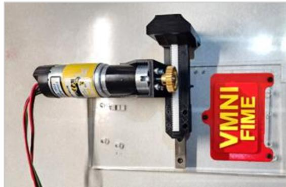
Figura 5. Base, Servomotor, brazo de compresión, engrane y cableado.
