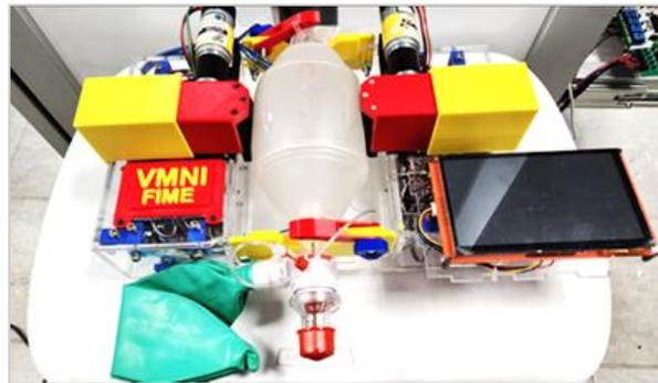
Figura 8. Ventilador Mecánico Terminado.
